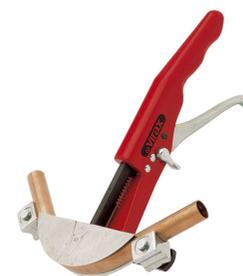
**CONSEIL** : Pour tube cuivre recuit au chalumeau : Ne recuire que la partie cintrée pour ne pas affaiblir le tube au niveau des contre-formes. Ne pas recuire le tube à l'endroit des contre-formes : risque de déformation.
