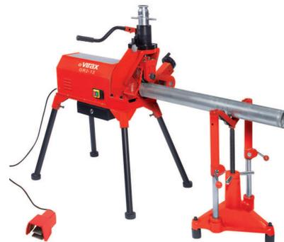
**Rainureuse électro-hydraulique**, pour la réalisation par moletage à froid de rainures sur tubes standard en acier et à parois minces Ø 2" – 12". Pour l'installation des systèmes de conduites, d'arrosage, les grandes installations de chauffage et industrielles.
