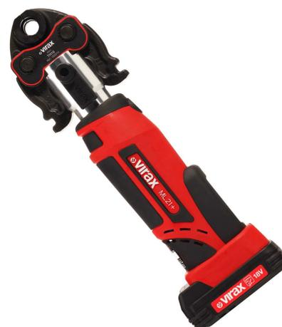
Sertisseuse électro-mécanique 20 kN sur batterie, avec retour automatique du piston.
