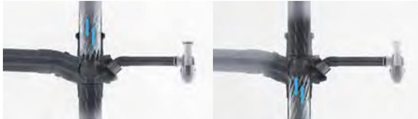
Le système Chutunic® permet un éclatement de l'eau contre la paroi interne du tube grâce à ses nervures spiralées associées à des culottes optimisées. Le piston hydraulique disparaît, permettant à l'air de circuler librement au centre du tube. Le désiphonage est ainsi évité, ainsi que les gargouillements et les odeurs.
