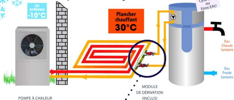
En hiver, Cylia EAU et Xiros EAU prélèvent les calories gratuites de l'air extérieur, par l'intermédiaire du générateur qui alimente le plancher chauffant, pour produire l'eau à 60°C.
