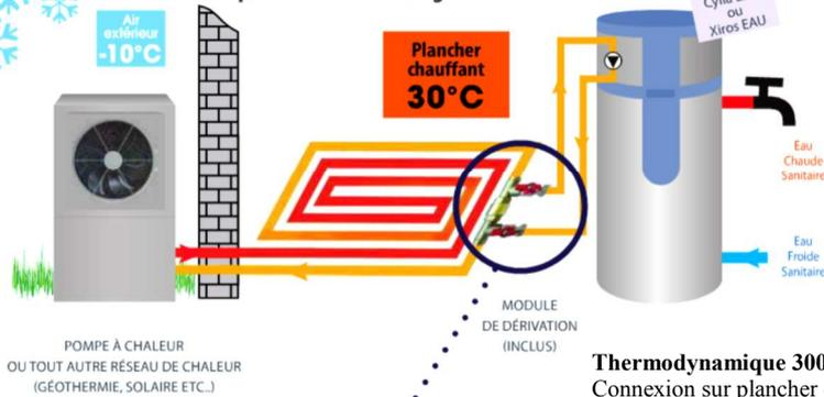
En hiver, Cylia EAU et Xiros EAU prélèvent les calories gratuites de l'air extérieur, par l'intermédiaire du générateur qui alimente le plancher chauffant, pour produire l'eau à 60°C.
