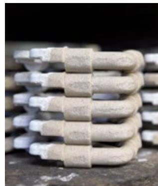
Des noyaux de robinet en sable siliceux sont utilisés pour la fabrication de tous nos robinets. Le sable est injecté dans le moule où il est traité à une pression de huit bars et à une température de 320 °C.
