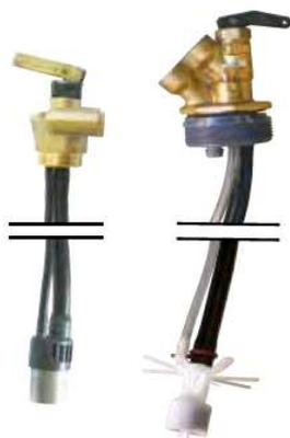
Dispositif complet comprenant : clapet de retenue à 2 billes plastique combiné avec vanne à fermeture rapide, raccords à bourrage, bouchon fileté R 2" avec raccord à bourrage, conduite d'aspiration flexible et conduite de jauge flexible avec pied plastique en étoile et contrepois.
