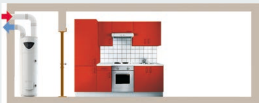
AIR EXTÉRIEUR AVEC GAINES POUR NE PAS REFROIDIR LA PIÈCE (DANS UN VOLUME CHAUFFÉ)
