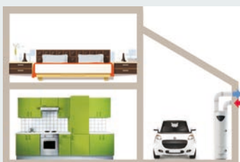
AIR EXTÉRIEUR AVEC GAINES POUR NE PAS REFROIDIR LA PIÈCE (HORS VOLUME CHAUFFÉ)
