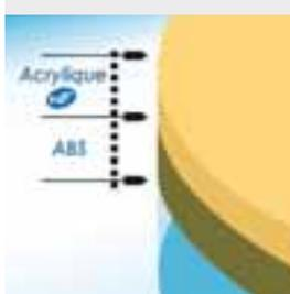
Matériau bi-matière constitué d'acrylique coulé grade sanitaire et renfort en ABS.
