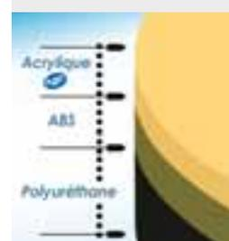
Matériau constitué d'acrylique coulé grade sanitaire et renfort bi-matière à base d'ABS et de Polyuréthane haute densité. Cette nouvelle technologie permet de fabriquer des baignoires mais également des receveurs.
